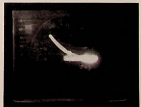
Bild 3b: Blauvektor und Burstlage bei einer Kamera-Kontrolle
