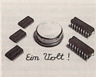
Bild 1: Mit 1 V Erhaltungsspannung kommt der neue 4Kbit-RAM aus (Valvo-Pressbild)
