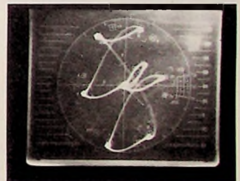
Bild 3a: Vektorbild am AV-Ausgang eines optimal abgeglichenen Farbfernsehers (Vergleiche mit Bild 2b)
